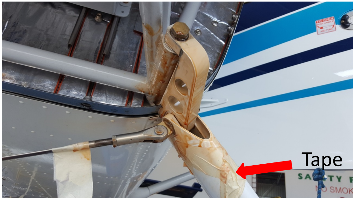
Plate 4: Mounting Point Sprayed with ARDROX AV 30™
