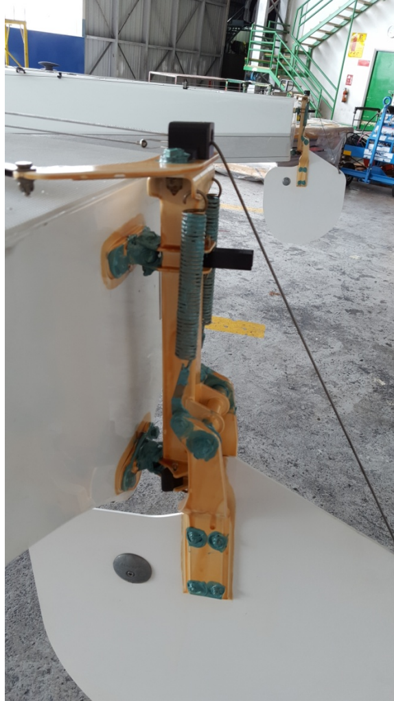
Plate 10: Rudder Assembly with AquaShield™ and ARDROX AV 30
